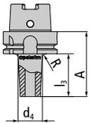
Die Maßangaben  $d_4$  und  $l_3$  bei Aufnahmen (siehe linke Skizze) sind bis zum theoretischen Schnittpunkt des Aufnahmekonus mit dem Aufnahmenbund gerechnet.
