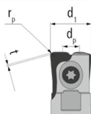
Bei der **CAD/CAM-Programmierung** der Werkzeuggeometrie ist ein Fräser mit theoretischem **Eckradius (r<sub>p</sub>)** einzusetzen. Werte sowie Angaben zum unzerspannten Bereich an **Restmaterial (t)** sind der Tabelle zu entnehmen. Die **Werkzeuflängenvermessung** erfolgt am Plandurchmesser „d<sub>p</sub>“.
