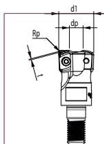
Bei der **CAD/CAM-Programmierung** der Werkzeuggeometrie ist ein Fräser mit theoretischem **Eckradius (r<sub>p</sub>)** 2,0 mm einzusetzen. Der unzerspannte Bereich an **Restmaterial (t)** beträgt damit 0,46 mm. Die **Werkzeuglängenvermessung** erfolgt am Plandurchmesser „d<sub>p</sub>“.
