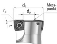
Bei der **CAD/CAM-Programmierung** der Werkzeuggeometrie ist ein Fräser mit theoretischem **Eckradius ( $r_p$ ) 2,3 mm** einzusetzen. Der unzerspannte Bereich an **Restmaterial ( $t$ )** beträgt damit **0,83 mm**. Die **Werkzeuglängenvermessung** erfolgt am Plandurchmesser „ $d_p$ “.
