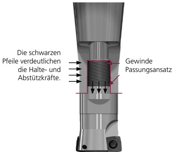
Die Standard-Einschraubverbindung wird mit bestmöglichen Toleranzen nach dem neuesten Stand der Technik gefertigt. Durch konstruktive Optimierungen des Werkzeugs und der Aufnahme wird die Leistungsfähigkeit des Pokolm-Einschraubsystems in erheblichem Maße gesteigert.
