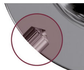
Wuchten durch Anbringen von Ausgleichsbohrungen Beispielrechnungen und Detailskizze auf der nächsten Seite.
